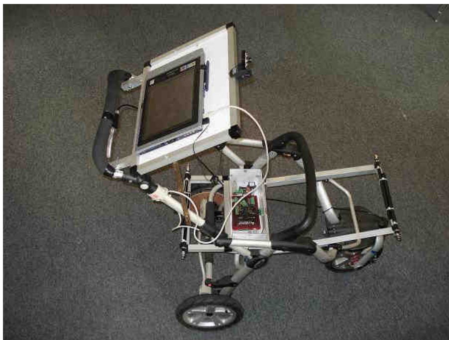
FIG. 9 – Unité de mesure mobile du projet Cartomobile.
