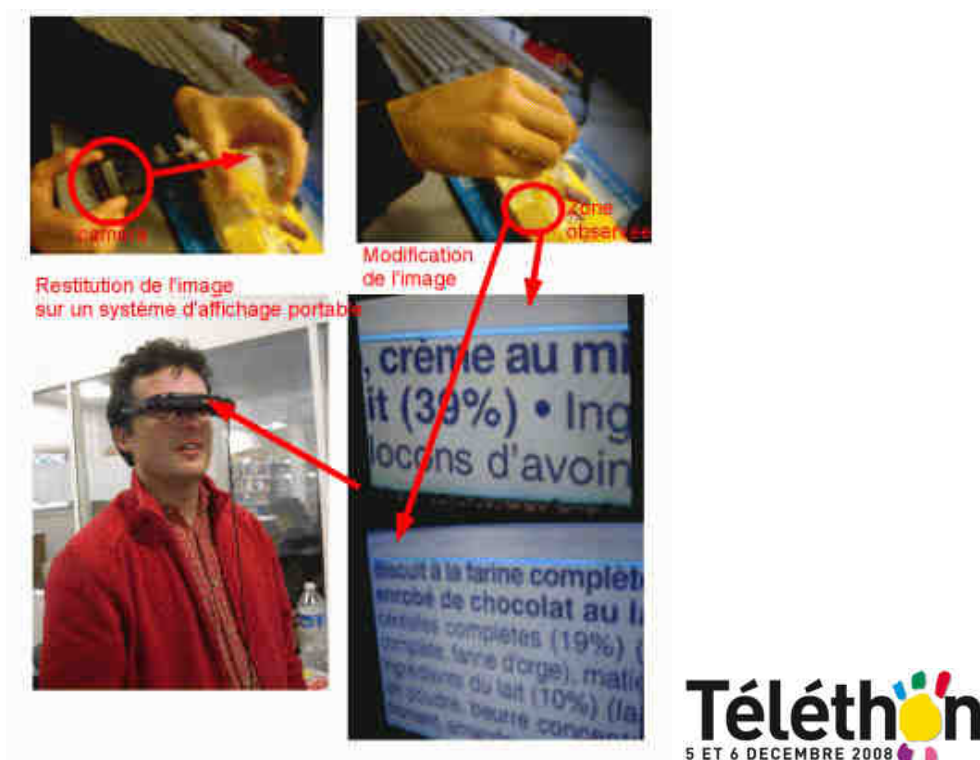
FIG. 7 – Principe de fonctionnement de la loupe numérique pour le défi technologique du Téléthon 2008.
