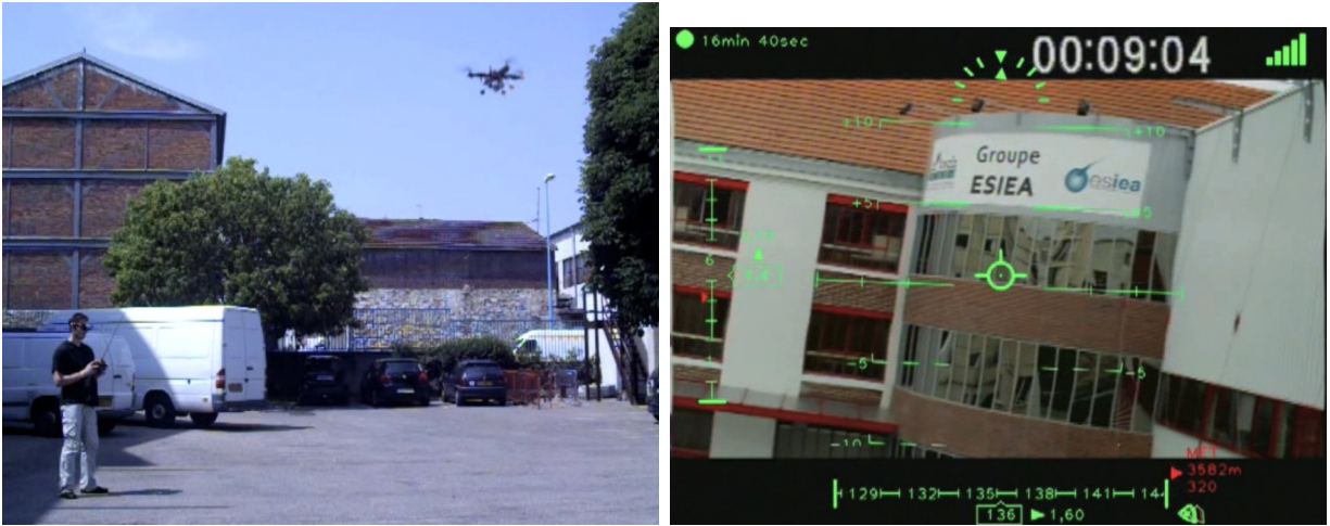
FIG. 10 – Le pilote a un casque de réalité virtuelle pour le pilotage en immersion (à gauche) dans lequel s’affiche la vidéo embarquée et les informations nécessaires à la mission (à droite).
