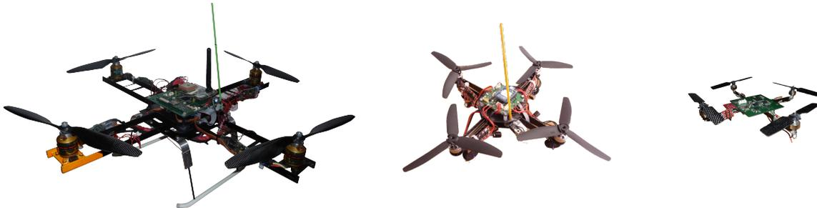
FIGURE 25 – Les prototypes à voilure tournante du laboratoire : Faucon Noir V1 (à gauche), Sparrow SP5 (au centre) et Moustik (modèle expérimental) (à droite).
