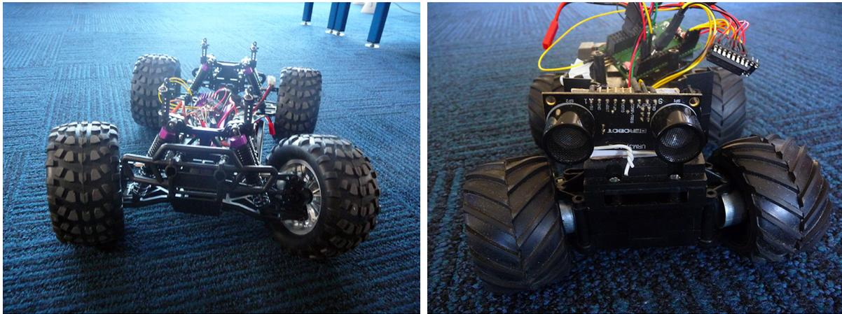
**Figure 31** – Le véhicule hacké Bl'hack Panther commandable par ordinateur (à gauche) et le capteur ultrasons (à droite).
